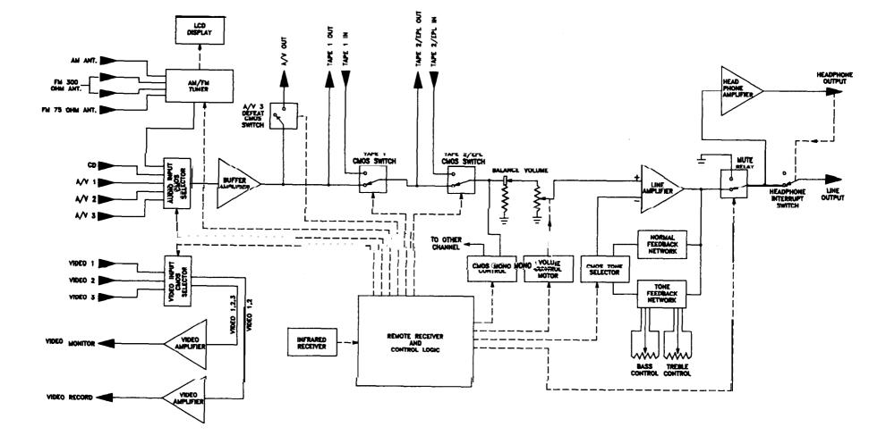
945 PREAMP/TUNER FUNCTIONAL BLOCK DIAGRAM
